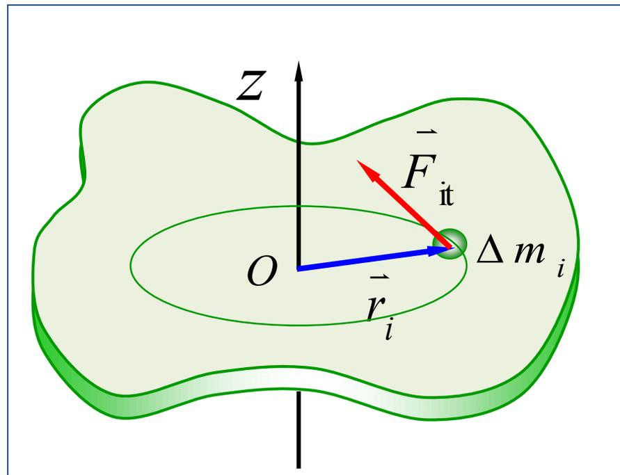
刚体定轴转动的角加速度与它所受的合外力矩成正比，与刚体的转动惯量成反比。
