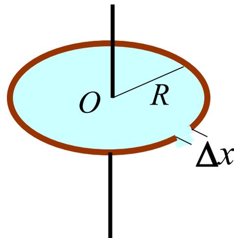
4. 求质量  $m$  , 半径  $R$  的均匀圆盘对中心垂直轴的转动惯量。
