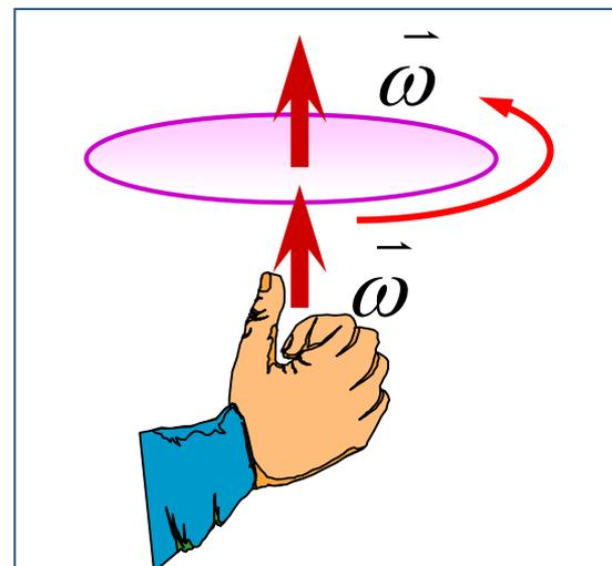
刚体**定轴转动**（一维转动）的转动方向可以用角速度的正负来表示。
